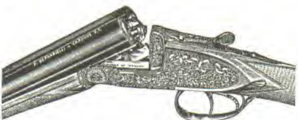
Orozare kao i hamerles puške mogu biti sa horizontalnim ili vertikalnim položajem cijevi.
